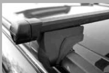
Barre di giunzione per autovetture con railing.
