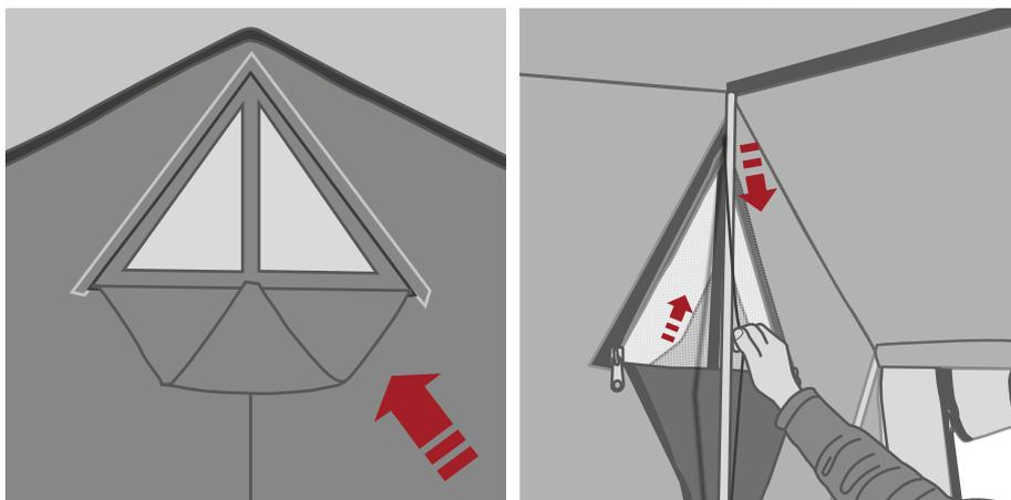
Ogni finestra ha una doppia chiusura con un oscurante protettivo esterno e un oscurante interno. Il tutto è facilmente manovrabile mediante una corda come la tapparella di casa, ma con il vantaggio di poter effettuare ogni operazione rimanendo comodamente sdraiati a letto. Per chiudere completamente le finestre non bisogna uscire dalla tenda.
