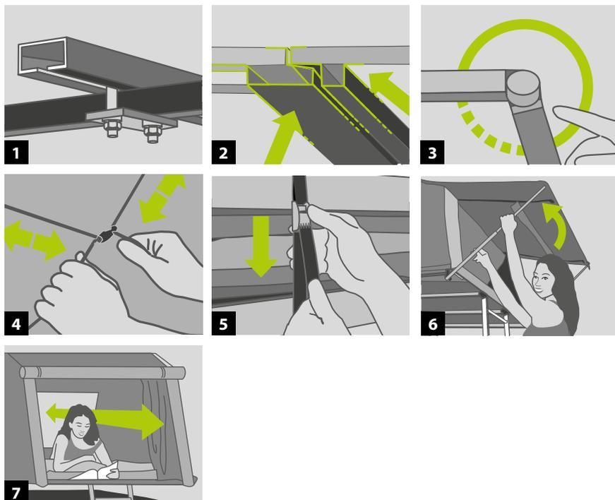
**1** - I due binari predisposti sotto la base e i relativi agganci permettono un rapido montaggio della tenda su qualsiasi vettura, consentendo inoltre di personalizzare la modalità di apertura: Standard oppure Explorer. Tutto avviene senza effettuare forature o interventi supplementari.
