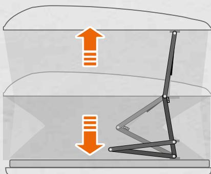
Il sistema è caratterizzato da quattro affidabili molle a gas che determinano un'apertura veloce e precisa. Non occorre neppure estendere manualmente i quattro braccetti di sostegno come avviene con i sistemi tradizionali.
