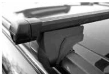
Barre di giunzione per autovetture con railing.
